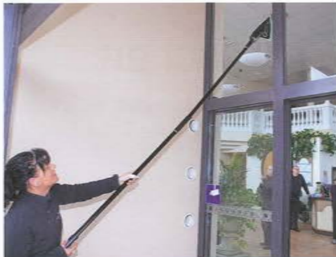
Im Innenbereich setzt Jeblick, wo immer es möglich ist, Stingray ein. Das System erlaubt Sprühen und Reinigen in einem Arbeitsgang.
